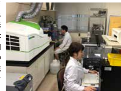
誘導結合プラズマ質量分析計 (ICPMS) を用いた水の分析風景
